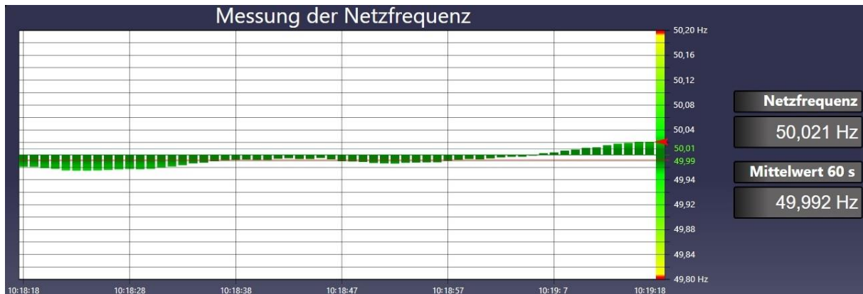
Abbildung 3 Detailansicht - Visualisierung der Netzfrequenzmessdaten im OHP Leitsystem ProWin
